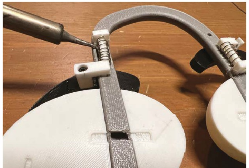
▲ Cosa c'è dietro gli occhi? Tra i componenti una molla di una penna retrattile, tagliata a metà
